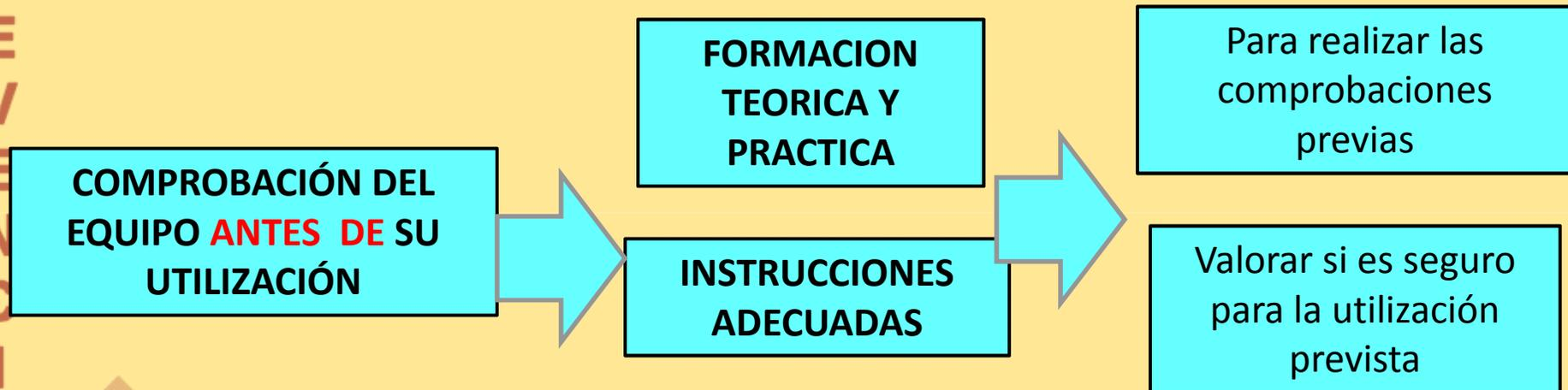
**UN OPERADOR FORMADO U OTRA PERSONA QUE REALICE LAS COMPROBACIONES** DEBERIAN SER CAPACES DE IDENTIFICAR DAÑOS EN LOS CABLES Y ACCESORIOS DE ELEVACION, DEFORMACIONES EN LAS CADENAS Y OTROS DEFECTOS OBVIOS QUE PODRIAN AFECTAR A LA SEGURIDAD DE SU FUNCIONAMIENTO
